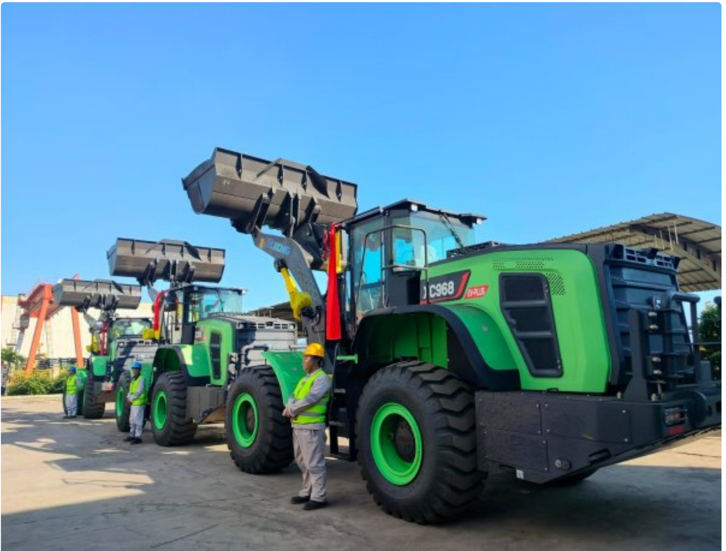
Loader Listrik Ramah Lingkungan milik PT IMIP
